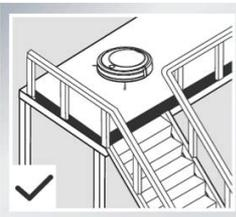
Ένα προστατευτικό φράγμα πρέπει να τοποθετηθεί σε σκάλες διπλού στρώματος για να βεβαιωθείτε ότι το προϊόν λειτουργεί με ασφάλεια σε περίπτωση βλάβης των αισθητήρων ελεύθερης πτώσης.
